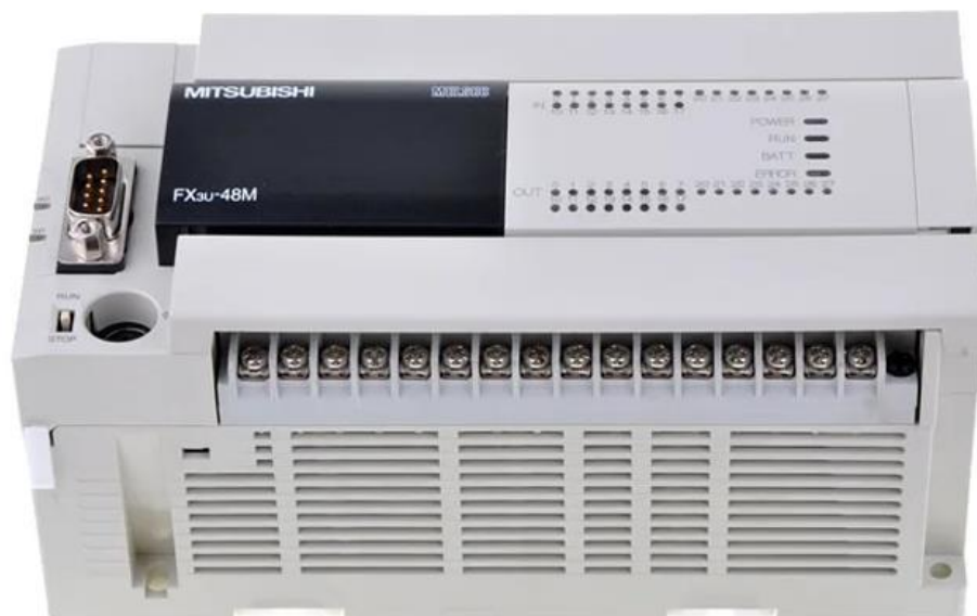
Hình 1.6. PLC Mitsubishi dòng FX
