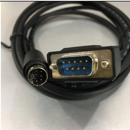
Hình 2.6-4a. Cáp kết nối HMI với PLC
